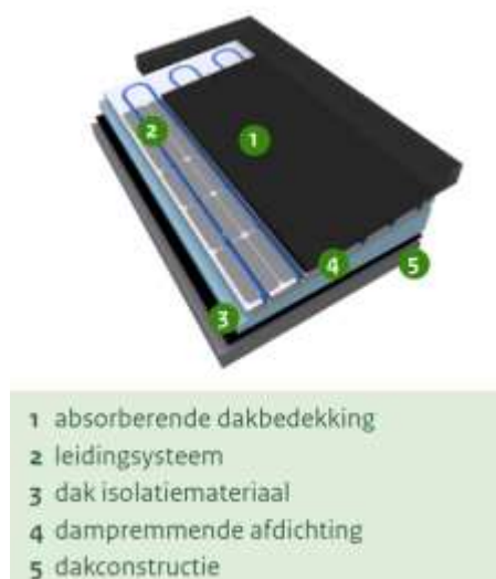
Figuur 7. Het principe van een Energiedak®
